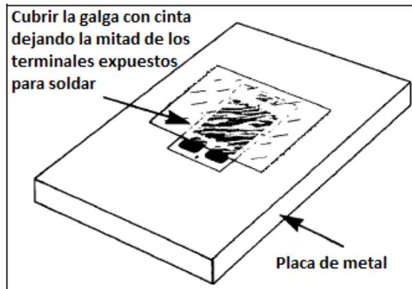
**Figura 3.11. Protección del área de la galga y parte superior de los terminales con cinta adhesiva.**
