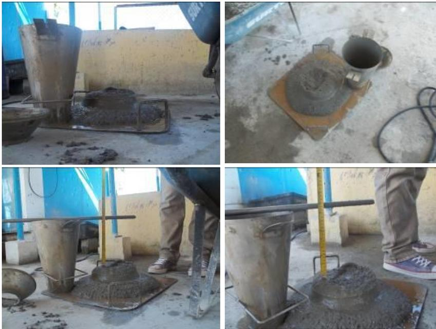
Fig. 2.31 “Medición del asentamiento por el cono de Abrams”
