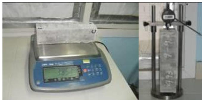
Fig. 2.26 “Balanza y defórmetro utilizado en la medición del peso y la longitud”
