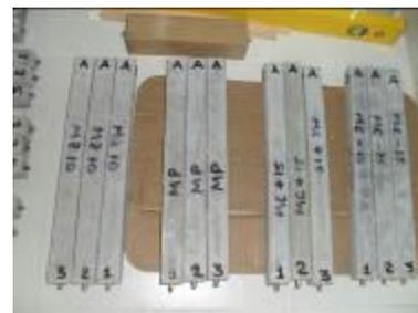
Fig. 2.20 “Probetas de mortero”
