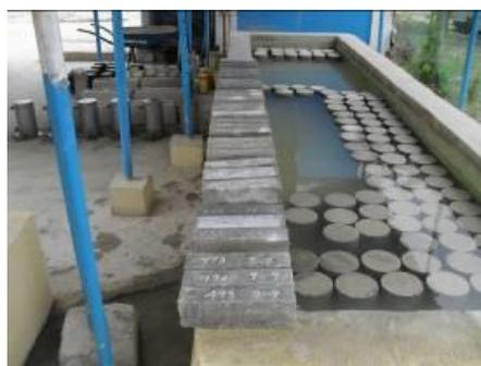
Fig. 2.32 “Probetas de hormigón colocadas en tina de curado tras 24 horas de hormigonadas”
