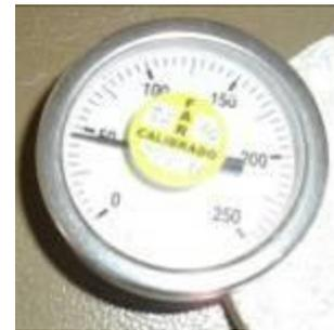
Fig. 2.25 “Termómetro para controlar la temperatura dentro de la estufa”
