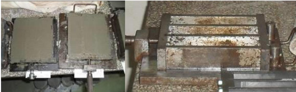
Fig. 2.28 “Moldes para ensayo de flexo-compresión en morteros”
