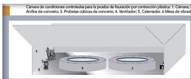
Fig. 1.7 "Cámara de prueba".
