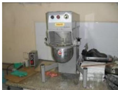
Fig. 2.30 “Mezcladora de morteros”
