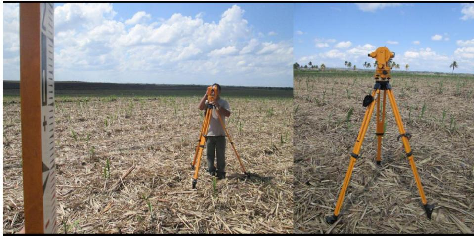
**Figura 2.1. Taquímetro DHALTA 010B para determinar el desnivel en el área experimental.**
