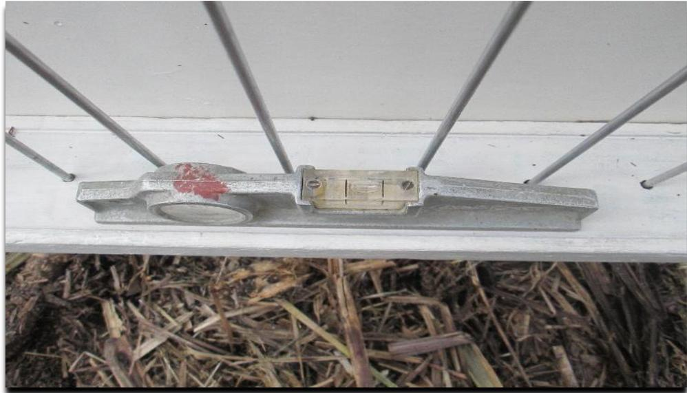
**Figura 2.3 Nivel de burbuja utilizado para nivelar el perfilómetro en el campo.**
