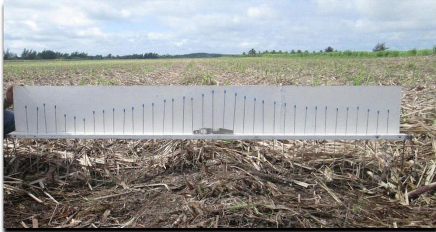
**Figura 2.2 Perfilómetro de varillas construido.**
