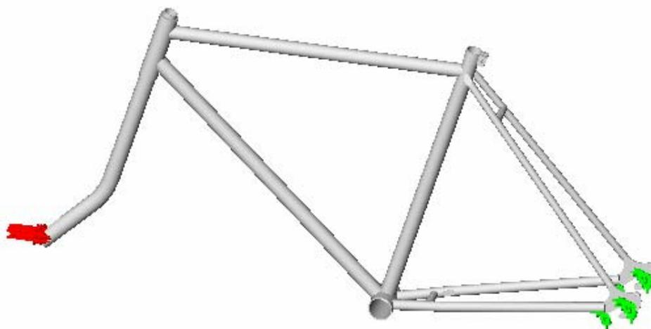
**Figura 3.5** Modelo de la bicicleta para el ensayo de Deformación.
