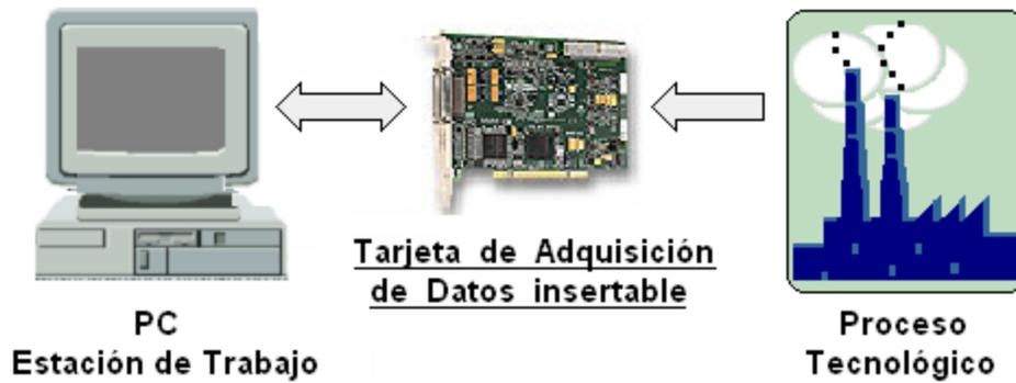
Figura 2.11. Sistema con el empleo de TAD y ordenador
