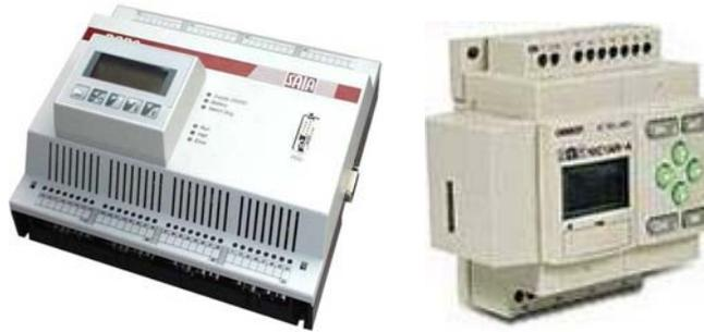
Figura 3.18. Autómatas compactos con capacidad fija de E/S
