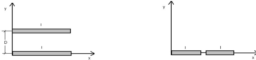
Figura 38: Disposición de dos conductores horizontales
