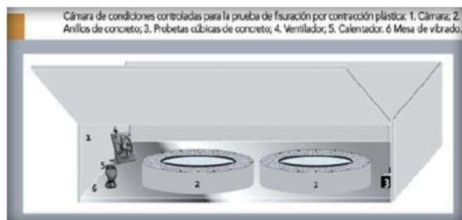
Figura N°1.17 Cámara de prueba.
