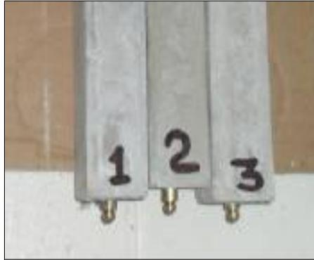
Foto 2.8 Puntos fijos de medición.
