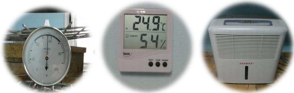
Foto 2.13 Equipos empleados para controlar la temperatura y la humedad en la habitación climatizada: Ciclo Sombra.
