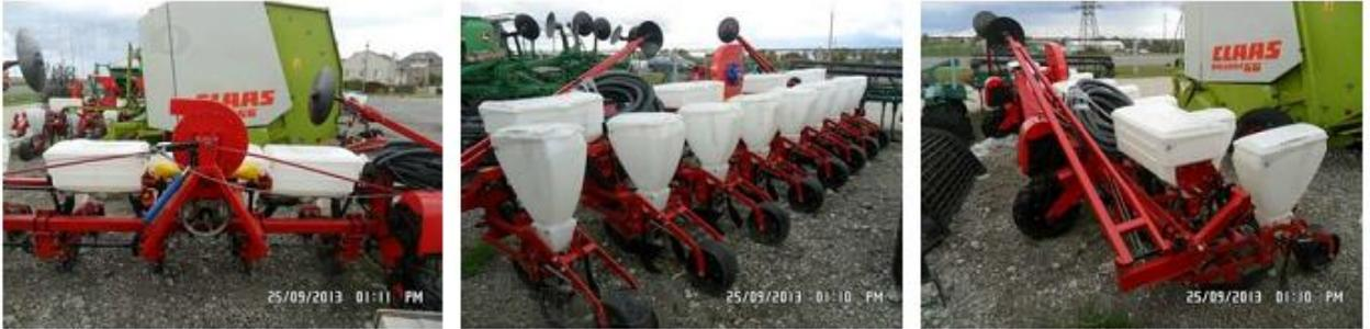
**Figura 1.3. Sembradora de granos neumática SUPN/8**
