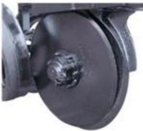
**Discos Sembradores Dobles:** Montados con rodamiento con rodamiento cónico (opcional).
