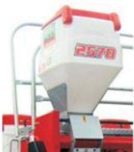
**Depósito individual de abono:** Capacidad de 75 litros (80kg). – Facilidad de descarga incluso en terrenos inclinados. No acumula abono. – Distribución de peso uniforme en el implemento. – Mejor autonomía en el abastecimiento.
