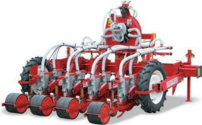
**Figura 1.5, Sembradora Gaspardo neumática de 4 líneas.**
