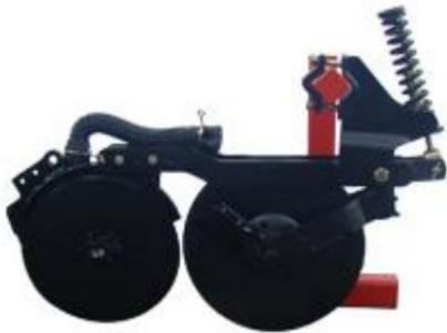
**Disco de Corte y Unidad de Abono:** – Disco de corte llano de 17" (estándar) – - Unidad de abono con disco doble desencontrado de 15" con rodamiento cónico. Viene con abresurco.
