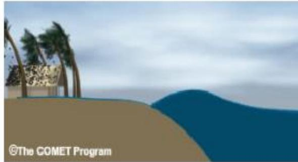
**Figura 1. 13.** Rompimiento de oleaje causante de la sobre-elevación del nivel del mar.
