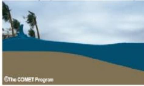
**Figura 1. 12.** Sobre-elevación del nivel del mar por arrastre del viento.
