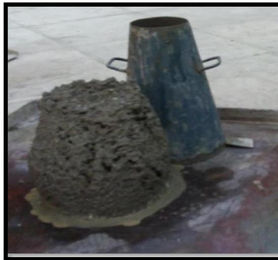
**Fig. 3.1 Consistencia por el Cono de Abrams.**
