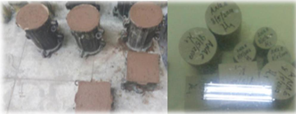
**Fig. 2.8 Llenado de los moldes y curado.**
