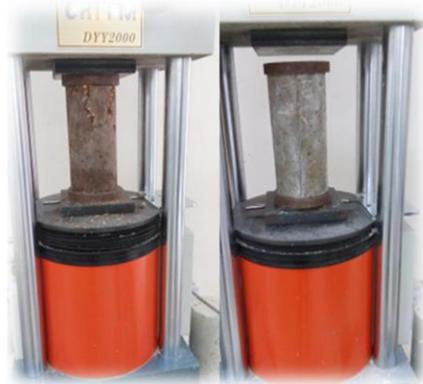
**Fig. 2.10 Resistencia a compresión de hormigones con LC<sup>3</sup>-50 (izquierda) y P-35 (derecha).**
