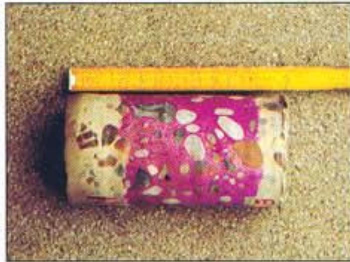
**Fig. 1.5** Ensayo de profundidad de frente carbonatado con aplicación de fenolftaleína.
