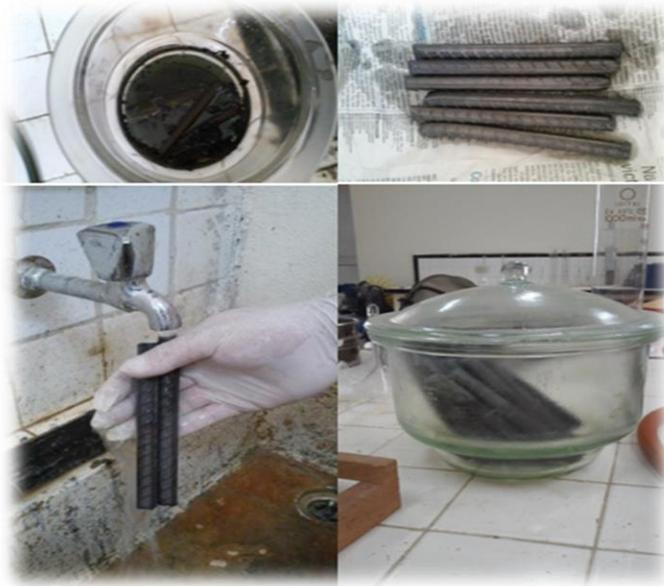
**Fig. 2.3 Preparación, limpieza y conservación del acero**
