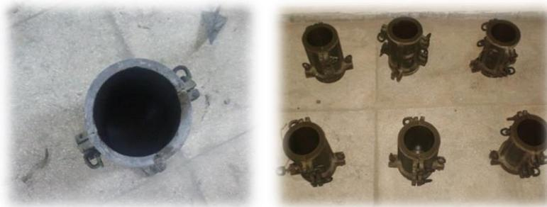
**Fig. 2.6 Moldes cilíndricos 150x300mm y 100x200 mm.**
