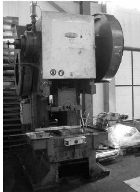
Figura 1.8: Prensa Hidráulica.
