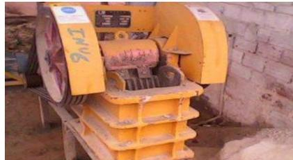
Figura 2. Molino de mandíbulas empleado para obtener el árido de hormigón reciclado.
