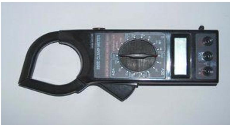
**Figura 5.** Amperímetro de gancho modelo (07564 CMI-100 GREENLEE).
