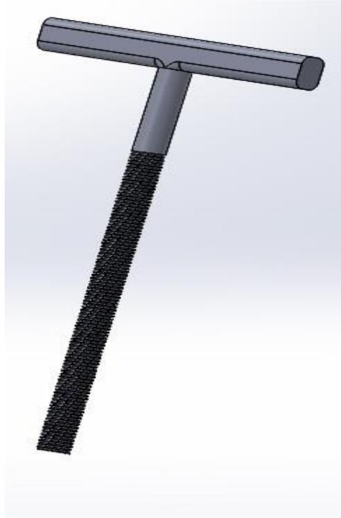
Anexo 5. El tornillo 14 x 2,3, es el encargado de rotar, por el cual se va realizando fuerza a la muestra.
