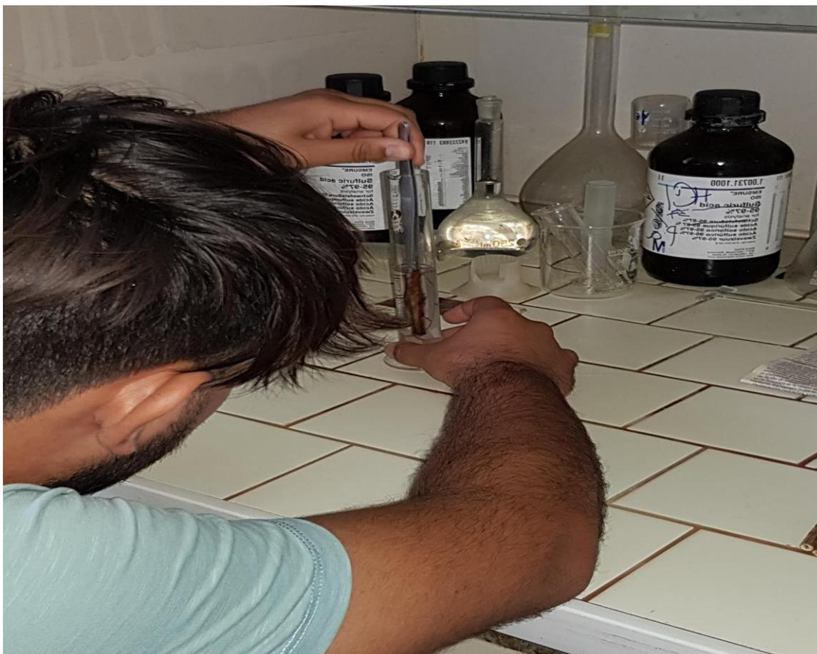
Figura 2.1. Realizando el método de Arquímedes (Arango *et al.*, 2011; Asoiro y Ani, 2011), para el cálculo de densidad.
