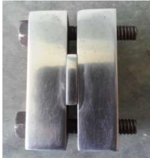
*Figura II.3: Muestra del perfil utilizado en los largueros del chasis lista para la metalografía*
