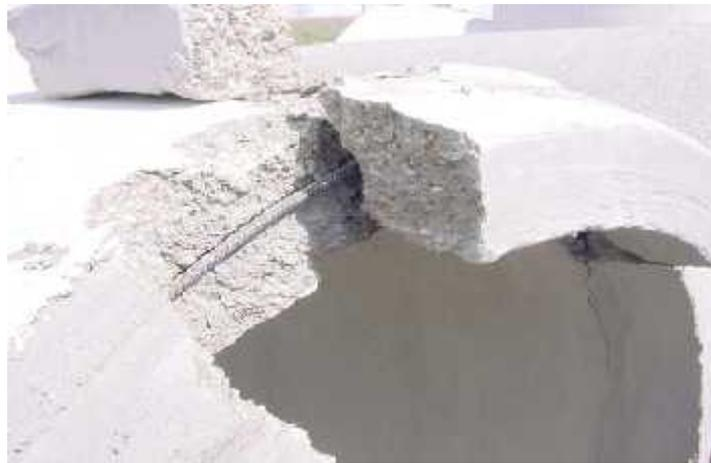
**Figura 10:** Boquilla de tubería de hormigón. Se detecta la falta de armadura en toda la boquilla.
