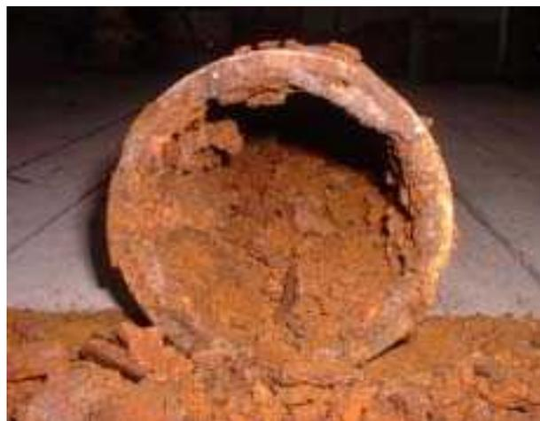
**Figara 25:** Incrustaciones en tubería de fundición.
