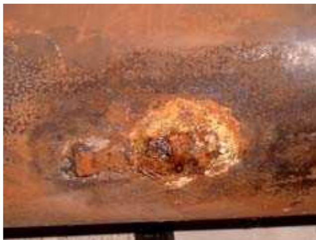
**Figura 27:** Patología por corrosión anódica debida a corrientes vagabundas.
