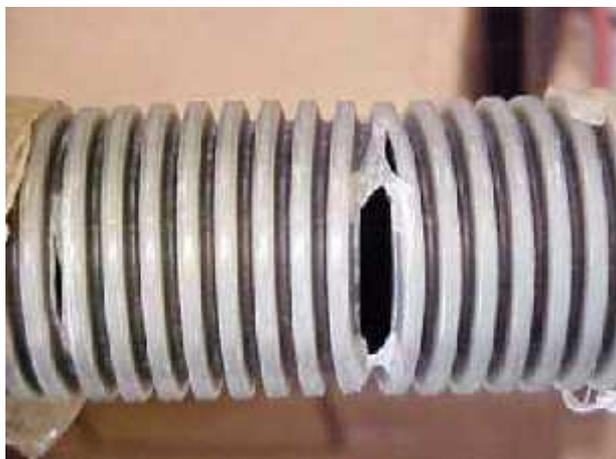
**Figura 28:** Envejecimiento y rotura en tubería de PVC por exposición aérea y por temperatura
