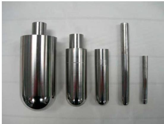
*Figura 2.2. Herramientas obtenidas de aceros de alta dureza [8]*
