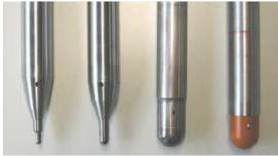
*Figura 2.1. Herramientas de carburo cementado utilizadas en el EIPS [14]*
