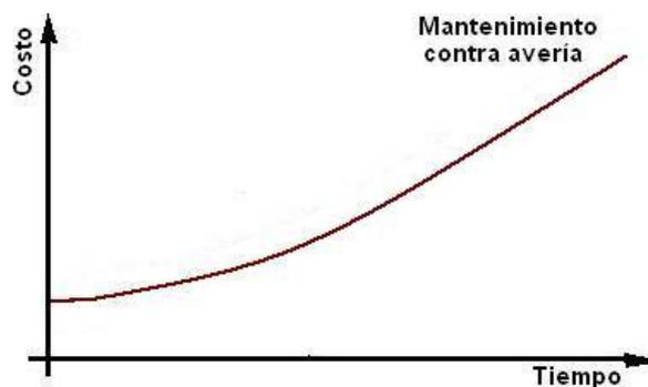
Figura 1.2. Comportamiento del costo del mantenimiento correctivo con el tiempo.
