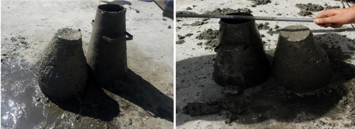
**Figura 3.2: Medición del asentamiento por el cono de Abrams**
