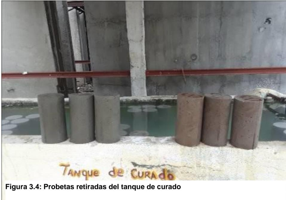
Figura 3.4: Probetas retiradas del tanque de curado
