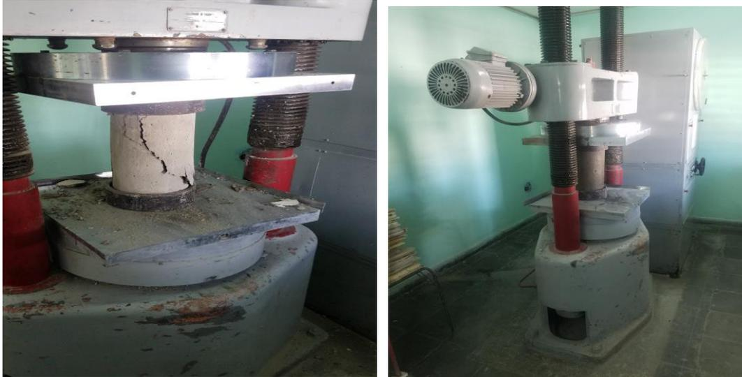
Figura 3.5: Ensayo de rotura de probetas para la determinación de la resistencia mecánica a compresión.
