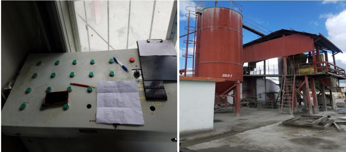
Figura 2.6: Planta de hormigón dosificadora mezcladora (**Batching Plant**); b) **Batching Plant**
