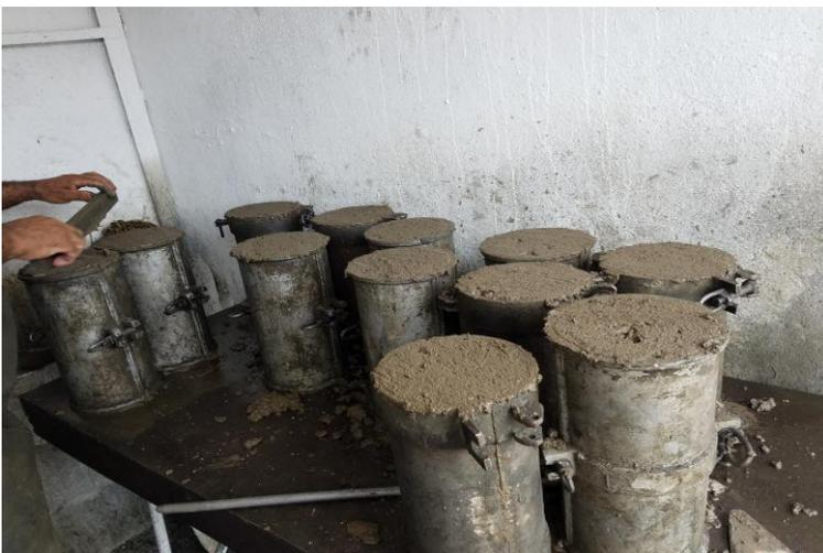
**Figura 3.3: Hormigón colocado en moldes para la elaboración de probetas.**
