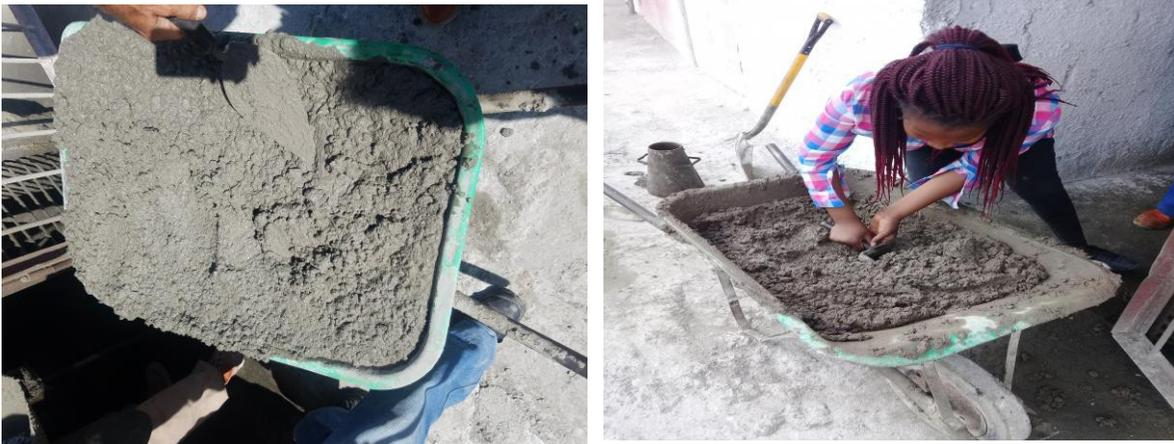
Figura 3.1: Hormigón en estado fresco a ser usado para la elaboración de probetas.
