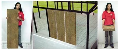
La presencia del aglomerado celuloso, combinado con los otros elementos en su estructura, determina una baja capilaridad y absorción de agua de los paneles fabricados con el compuesto ecobioconstructivo, los que presentan una absorción total final inferior a la de la albañilería de ladrillo tradicional. El diagrama que se muestra a continuación muestra el bajo coeficiente de absorción de agua (W) para el ecobiocompuesto.
