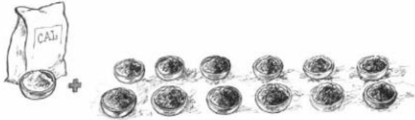
**Fig. 16** La forma de estabilizar el suelo
