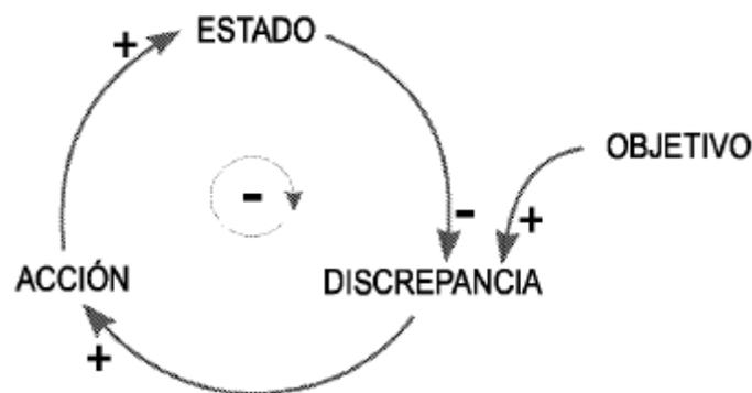
Figura 3. Diagrama básico de un bucle de realimentación negativa (Aracil, 1995)
