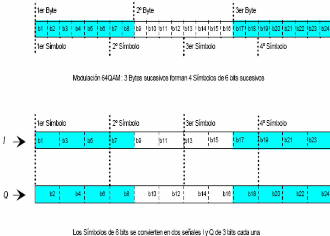
**Figura 1.15 “Mapeado” para modulación 64-QAM.**
