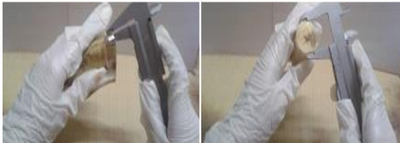
Fig 2.3. Medición del grosor de la cáscara y la pulpa del fruto. Fuente: Archivo del autor.
