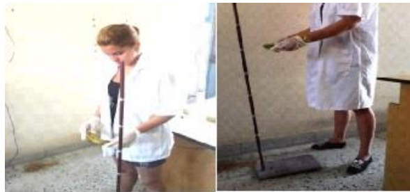
Fig 2.8. Instrumentos utilizados para la caída libre. a) Instrumento manual con almohadilla de poli espuma; b) Instrumento manual. Fuente: Archivo del autor.
