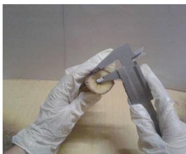
Fig 2.4. Medición de la profundidad del impacto. Fuente: Archivo del autor.
