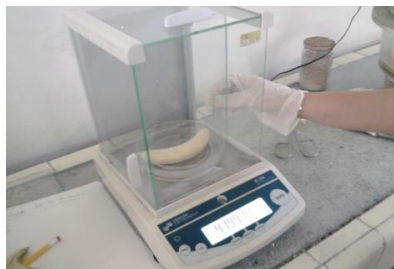
Fig 2.6. Balanza analítica para la determinación del peso. Fuente: Archivo del autor.
