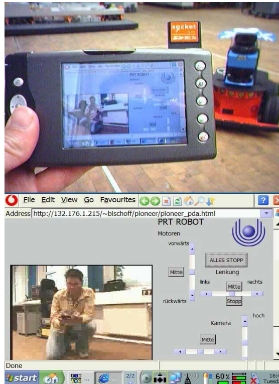
Figura 1.11: Web y Java AWT basada en una GUI omnidireccional
