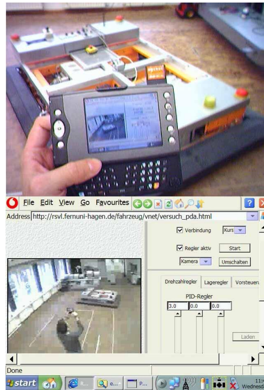
Figura 1.10: GUI experimental del robot móvil para Smartphone (640x480 pixel)
