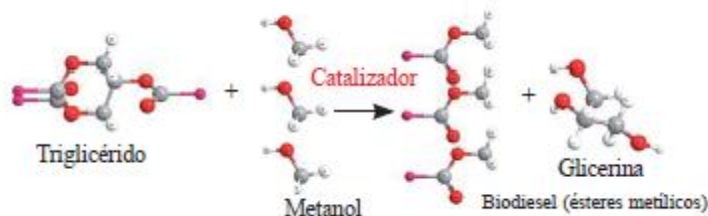
Figura 1.2. Reacción de transesterificación para la producción de biodiesel.
