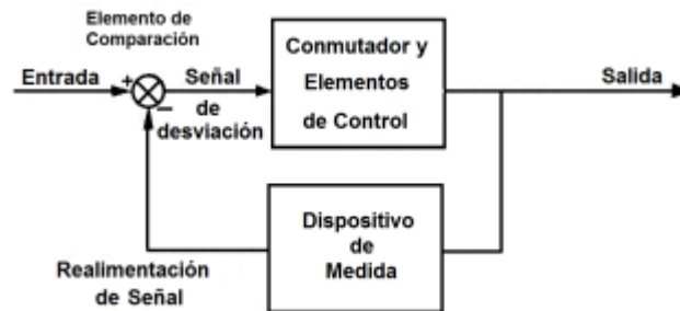
Figura 1.3. Sistema de control de lazo cerrado o realimentado [11].
