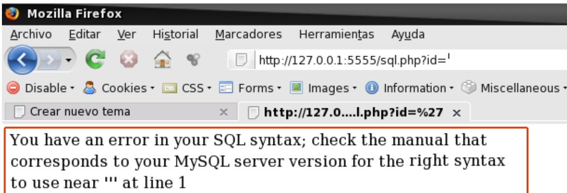
Ilustración 1.6 Error mostrado por una página web vulnerable a inyección SQL, en este caso el SGBD que interactúa con el servidor web es MySQL.
