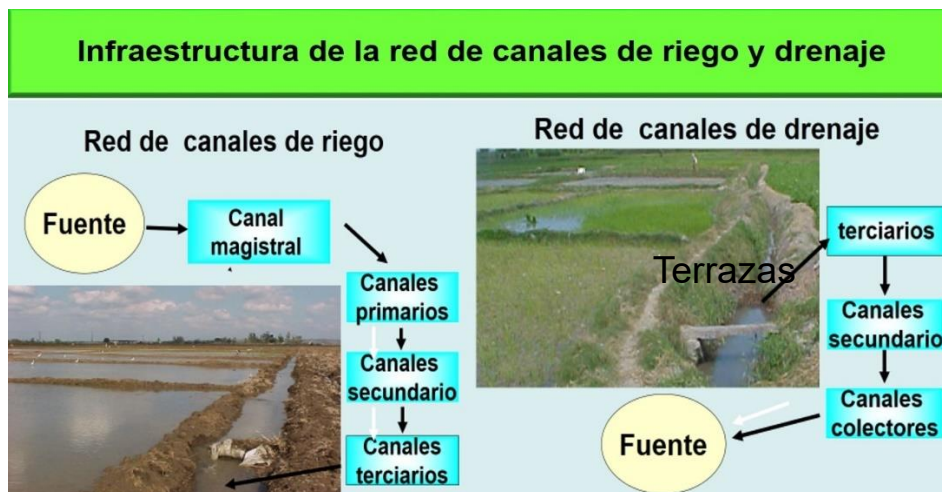
Figura 1.1. Recorrido del agua desde la fuente a la terraza en el cultivo del arroz
