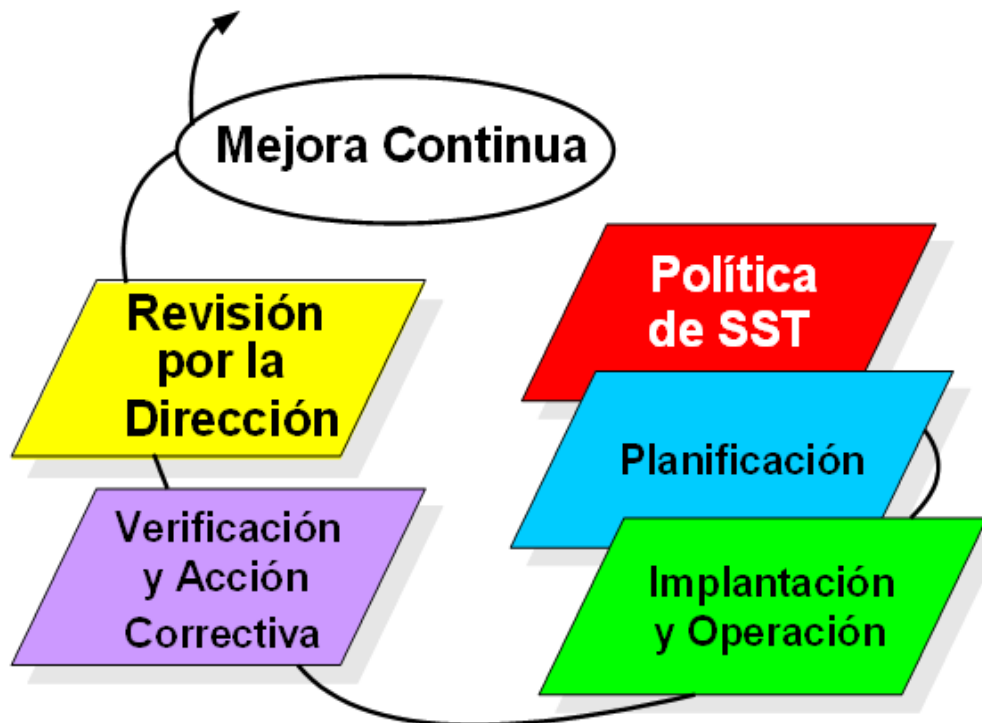
Figura 2. Ciclo de mejora continua de los elementos del sistema de gestión de la seguridad y la salud ocupacional según NC 18001: 2005 (Fuente: NC 18001: 2005).
