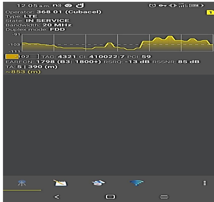
Figura 2.4 Vista de la aplicación NetMonitor [53].
