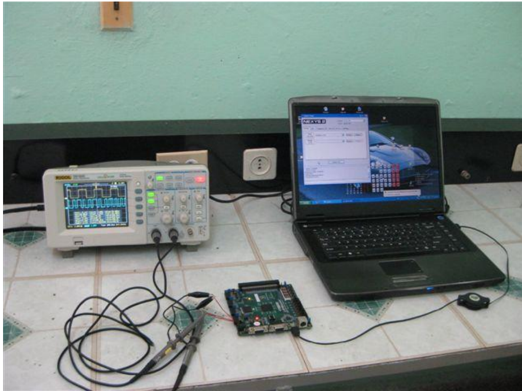
Figura 3.10. Modulador BPSK implementado en el Kit Nexys2.
