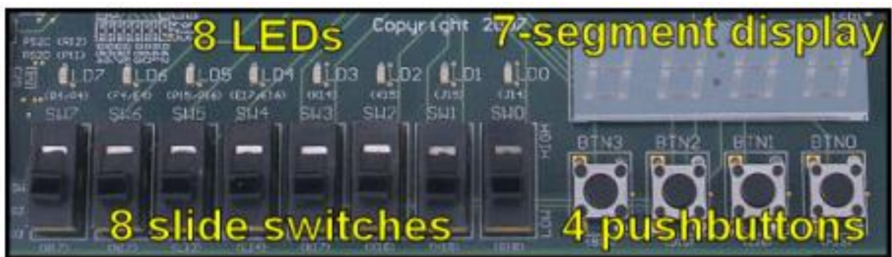
Figura 1.4. Dispositivos I/O (Digilent, 2008).
