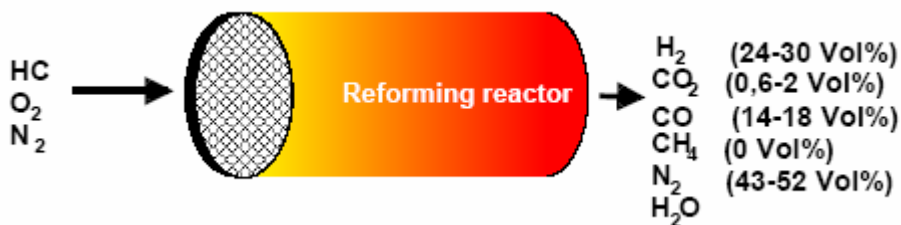
Figura 1.2. Reformador de Oxidación Parcial.
