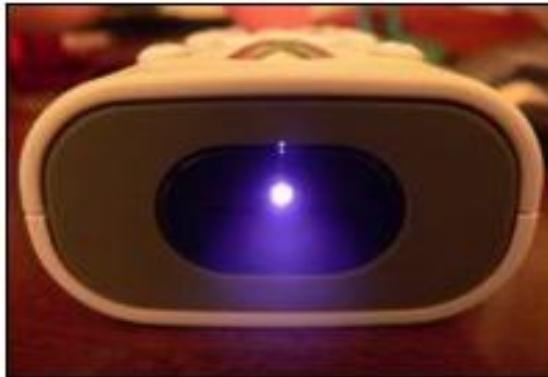
Figura 1.2. Luz IR vista con el CCD de una cámara digital.
