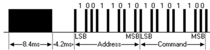
Figura 1.12. Estructura de la trama para el protocolo JVC.
