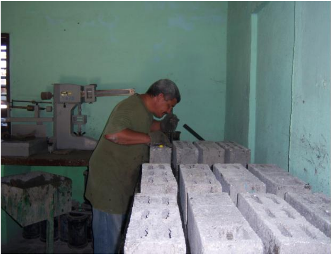
Figura 7 Realización del recape al bloque.
