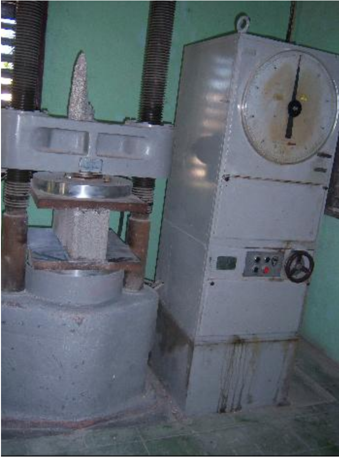
Figura 6 Prensa para el ensayo a compresión del bloque.
