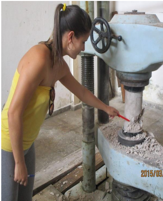
Fig. 2.4 Ensayo de resistencia a compresión de las probetas del CIDC.
