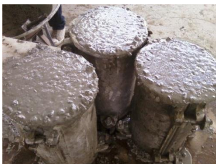
Fig. 2.2. Compactación de las muestras
