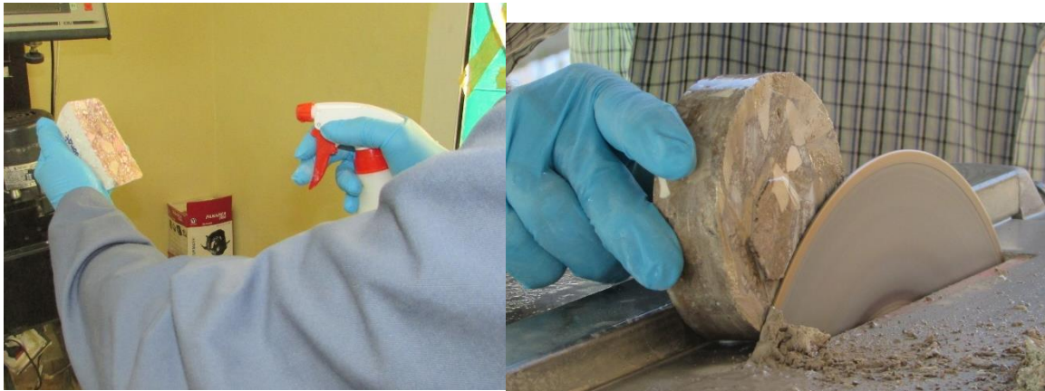
Fig. 2.7 Muestras para el ensayo de carbonatación de la EPI.
