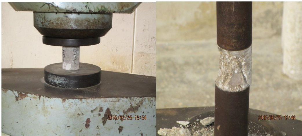
Fig. 2.5 Ensayo de resistencia a compresión de las probetas de la EPI.
