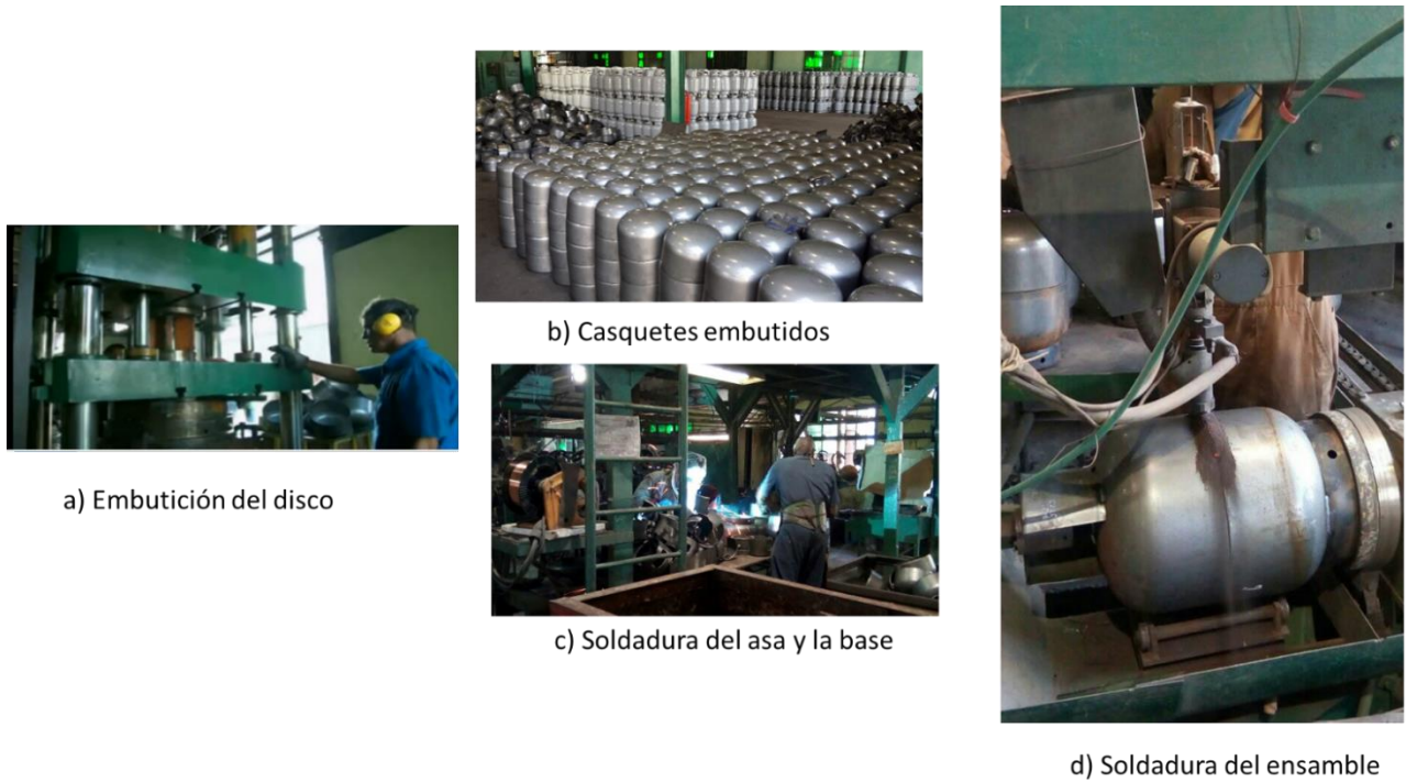
Figura 5. Imágenes representativas de algunas etapas de producción del cilindro de 10kg, en la fábrica Noel Fernández, de Matanzas. Fotos tomada [16]
