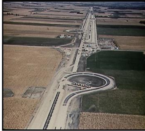
Figura 1.4 Ensayo realizado en Ottawa, Illinois. Fuente: Guía AASTHO 1993
