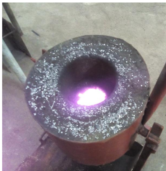
Figura 2.1 Reactor de grafito durante el procesamiento aluminotérmico
