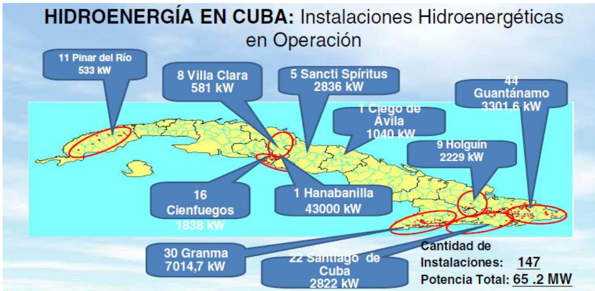
Figura 6: Instalaciones hidroenergéticas en Cuba.
