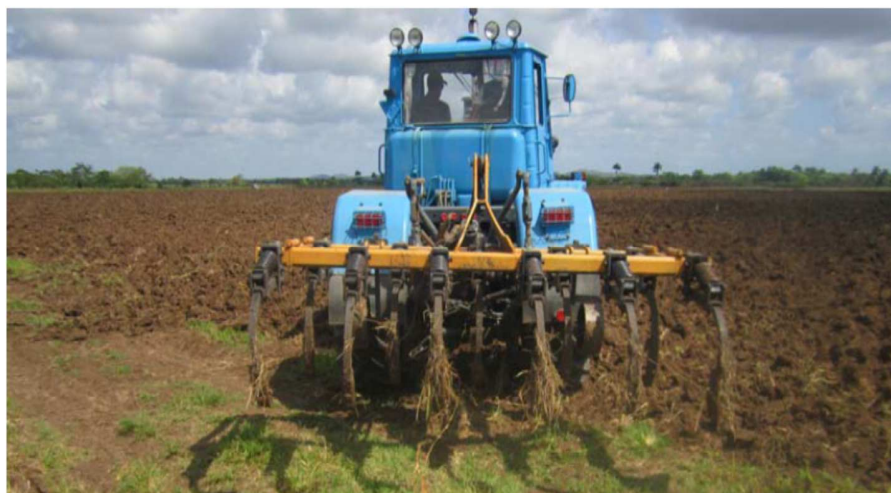
Figura 7. Tiller de profundidad media de 11 órganos CHR-11P
