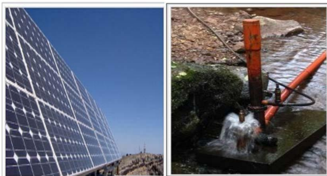
Figura 19: Panel solar y Ariete hidráulico. Fuente: Freire, 2013.
