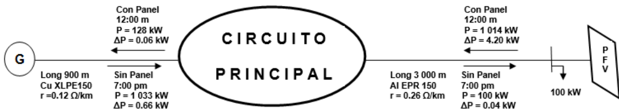
Figura 3.4 Esquema simplificado del circuito del delphinario donde se muestra el incremento de las pérdidas al conectarse y desconectarse el PFV
