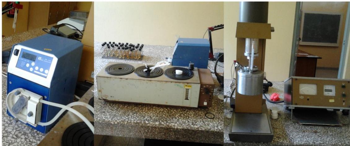
Figura 4 Bomba peristáltica, baño de agua y viscosímetro Rheotest.
