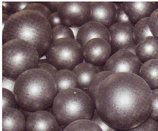
Fig. 2.1 – Fotografía de diferentes bolas utilizadas dentro de un molino de bola. Fuente: Fotografía propia.
