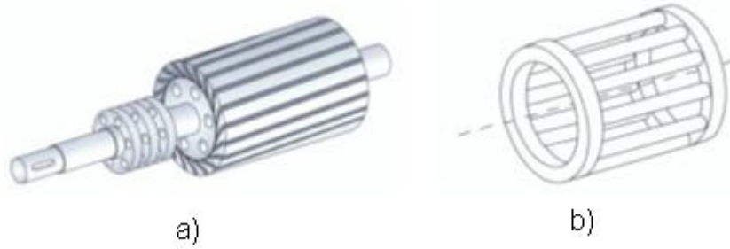
Fig. 1.2 Tipos de rotor a) rotor bobinado b) rotor jaula de ardilla
