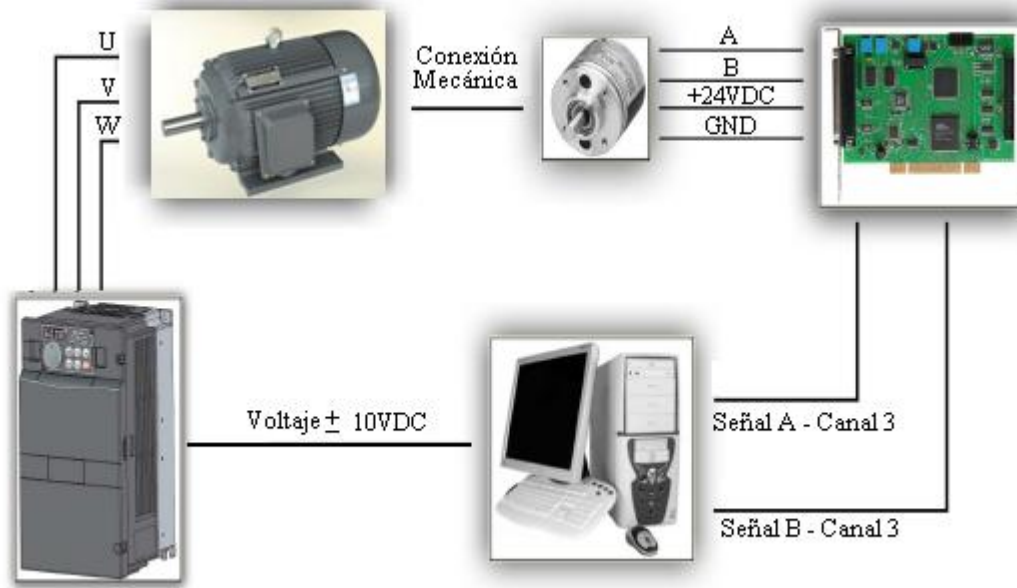
Fig. 2.3 Esquema general del conjunto motor-inversor para el control.
