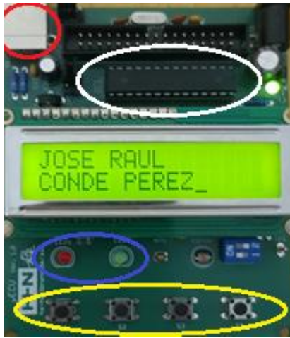
Figura 2.1. Microcontrolador ATmega88PA, led 1 (izquierda), led2 (derecha), botones S1, S2, S3, S4 (de izquierda a derecha) y conector USB.
