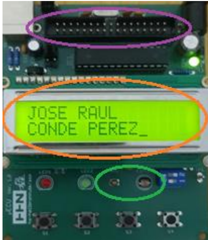
Figura 2.2. Interfaz serial FT232 BL, termistor (izquierda), fotorresistencia (derecha) y LCD-Display 162C .
