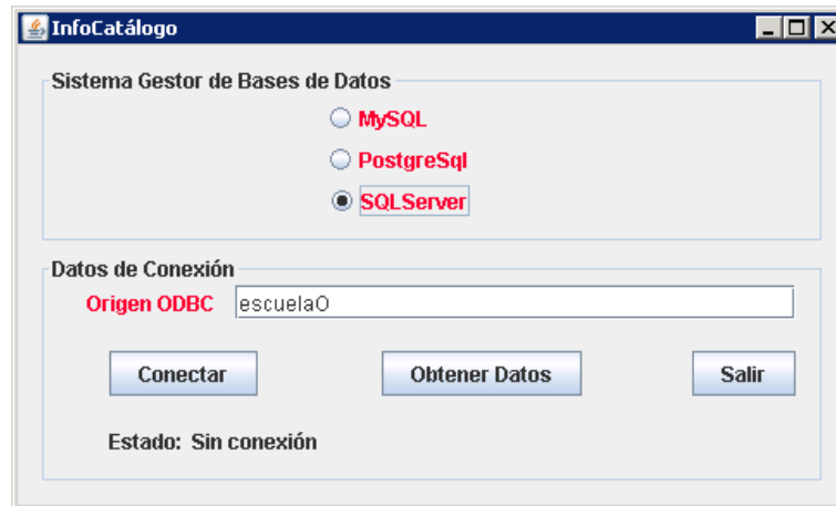
Figura 34: Interfaz de la herramienta InfoCatálogo (información necesaria para obtener los Metadatos en SQL Server).
