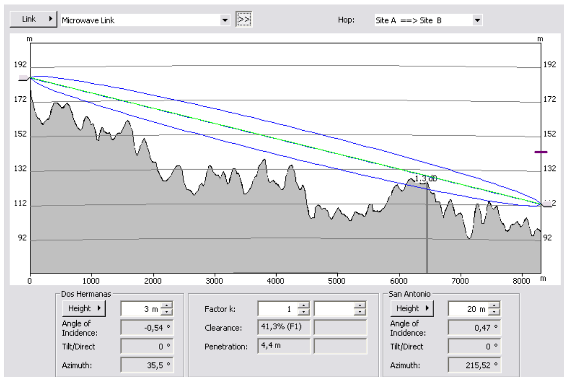
Figura 3.2: Análisis del perfil del enlace de microondas
