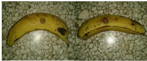
Fig 3.5. Detalles de los daños producidos por diferentes energías de impacto. a) E= 105.94 (J); b) E=116.54 (J).
