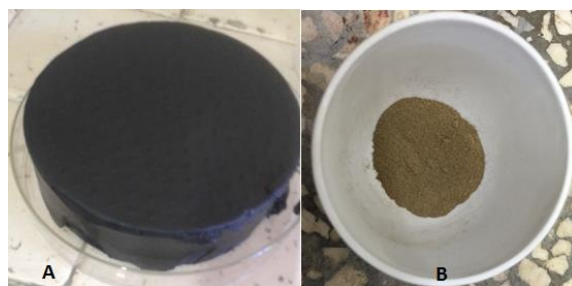
Figura 3.3. Producto recuperado, filtrado al vacío (a) y luego de calcinado (b).
