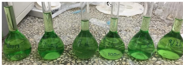
Figura 3.1. Soluciones preparadas del residuo sólido para ser analizados en EAA Para la cuantificación de vanadio se utilizó la espectroscopia UV-Visible, ya que se forma un complejo rojo cereza entre el H_2O_2 y el vanadio, como se observa en la Figura 3.2.
