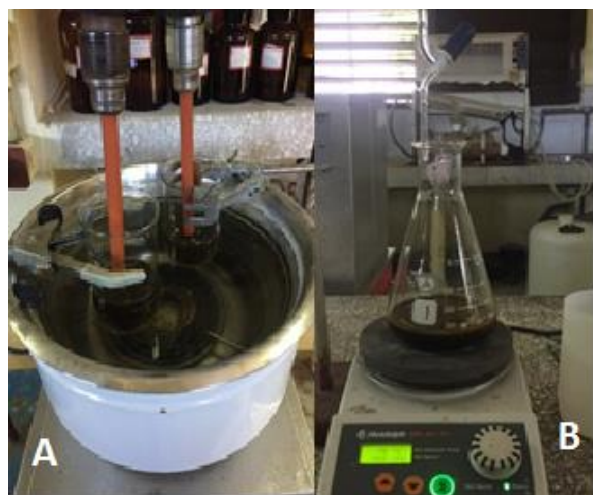
Figura 2.2. A) Equipamiento utilizado para la lixiviación, B) Equipamiento utilizado para la precipitación.
